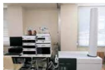
液体クロマトグラフ・飛行時間型質量分析計 (Q-TOF LC/MS)
