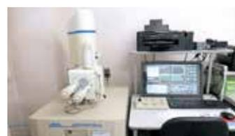
エネルギー分散型X線装置 (EDS)
